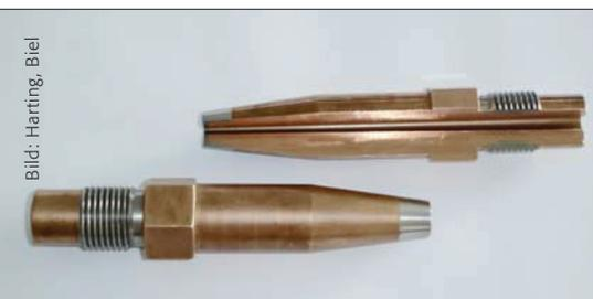
Bild 1: Maschinendüse, Bindeglied zwischen Plastifizierungseinheit und Spritzgiesswerkzeug.
