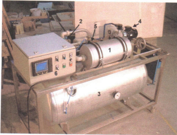
Bild 2. Prüfstand zur Druckverlaufs-messung
