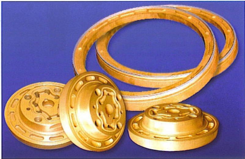
Optimal: Diese Formeinsätze für die Deckel- und Eimerherstellung bestehen aus der berylliumhaltigen Kupferlegierung Hovadur K350. Dank gleichmäßiger Werkzeugwandtemperatur hat sich die Spritzteilqualität verbessert und die Zykluszeit deutlich verringert.
