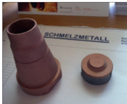
Bild 4: Formkern und Angusseinsatz in Hybridbauweise.
