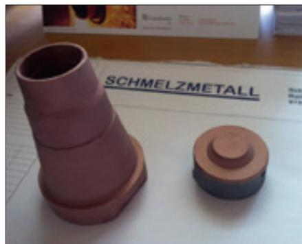
Bild 4: Formkern und Angusseinsatz in Hybridbauweise.
